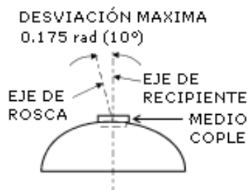
Figura 15 - Concentricidad y desviación del medio cople con el recipiente
